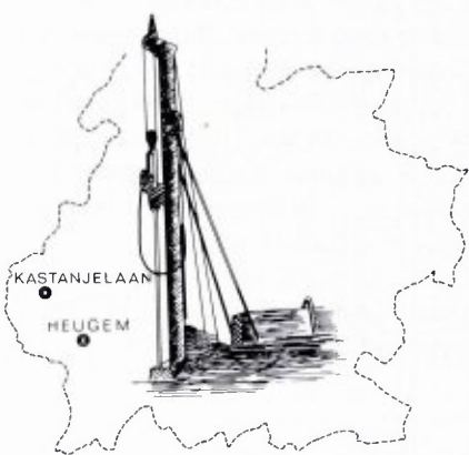
Figuur 1. Voor het afdiepen van de 500 m diepe boringen Heugem en Kastanjelaan in de gemeente Maastricht werd door de boorondernemer (de firma R. Gruner uit Sittard) een voor Nederland uniek boorsysteem toegepast; de "wireline". Deze oorspronkelijk in Frankrijk ontwikkelde methode wordt thans over de gehele wereld toegepast in de exploratie naar vaste delfstoffen, zoals steenkool en erts.
